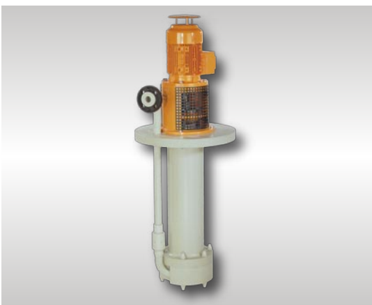
Verticale kunststof centrifugaalpomp type TNP of TNP-KL Met labyrint- of mechanische asafdichting, voorzien van glijlagers, lengte max. 3.000 mm
