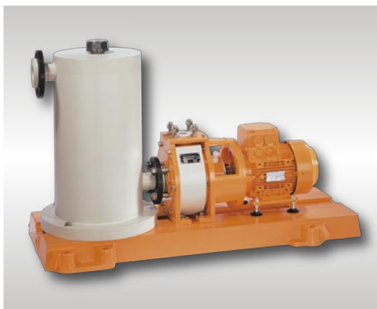
Aanzuigvat Met een aanzuigvat kan een standaard centrifugaalpomp zelfaanzuigend worden gemaakt.
