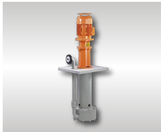
Verticale kunststof centrifugaalpomp type TPC of TPC-M Cantilever ontwerp, met labyrint- of (dubbel) V-ring afdichting, lengte 600 - 1.800 mm
