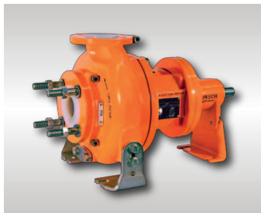
Kunststof beklede centrifugaalpomp type ECM Met magneetkoppeling, voor lichtere toepassingen. Ook verkrijgbaar in blokbouwwitvoering ECM-B.
