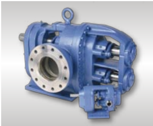
Roterende plunjerpom (lobbe) type HD/ID Bij dit pomptype wordt er gebruik gemaakt van een externe tandwielkast, waardoor er geen metaal-metaalcontact bestaat tussen de roterende plunjers en zelfs droogloop mogelijk is. De pomp is verkrijgbaar met een enkelzijdige en dubbelzijdige lagerconstructie waarbij de dubbelzijdige lagerconstructie, bestand is tegen extreem hoge drukken. Tevens is dit type uitermate geschikt voor het verpompen van vloeistoffen waarin vaste delen voorkomen.
